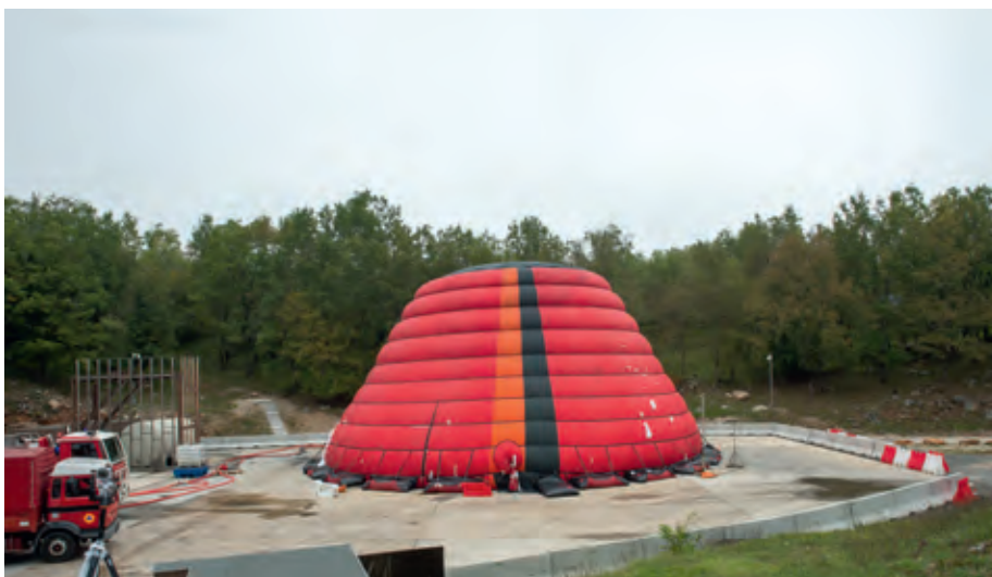
← Exercice de confinement d'explosif par cône et mousse acqueeuse sur le Centre de Gramat en 2013
